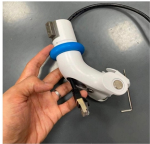
水晶头从底部椭圆孔拉出
