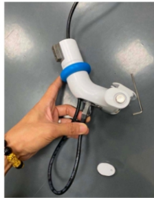
水晶头反向穿入底部椭圆孔
