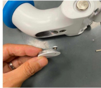
将底下椭圆塞块及螺丝取出
