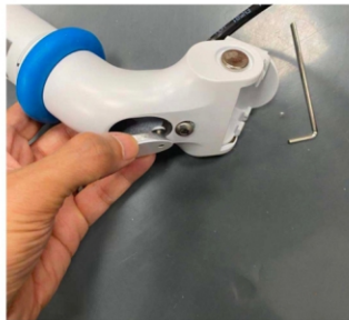
将椭圆塞块, 如图所示扣回
