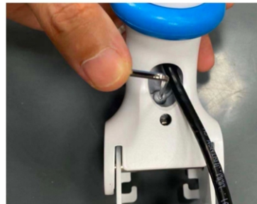
用S2.5六角扳手将螺丝拧紧
