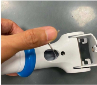
拧松内部一颗M4螺丝 (拧松一半, 螺丝不用完全退出)
